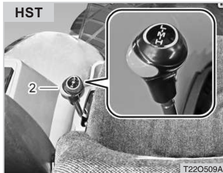
(1) Main Shift Lever (2) Range Shift Lever
