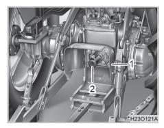
(1) P.T.O Shaft Cover (2) P.T.O Shaft Cap
