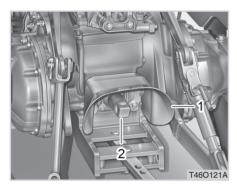
(1) PTO Shield (2) PTO Shaft Cap
